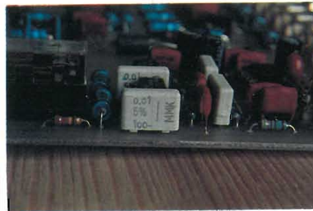
Foto 3 - Nell'equalizzatore R.I.A.A. si impiegano condensatori al 5% di tolleranza.
